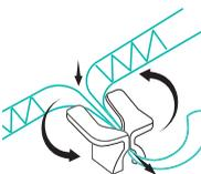
5 - Après l'installation, vérifier que le clapet n'est pas bloqué et peut s'ouvrir et se fermer normalement. Positionner l'arrière du sac afin de lui éviter d'être pris dans le couvercle.
