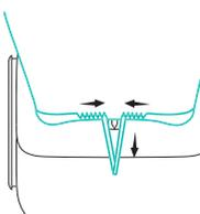
4 - Insérer le cordon de serrage dans l'espace prévu, serrer et enrouler.
