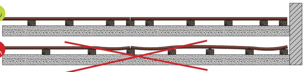
Chaque extrémité de lame doit avoir 2 lambourdes espacées d'un entraxe de 180 mm maxi. Pour la fixation des lames, voir page 10.
