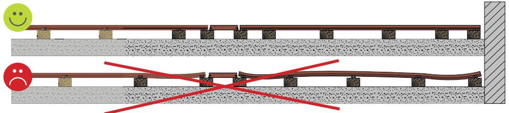
Chaque extrémité de lame doit avoir 2 lambourdes espacées d'un entraxe de 180 mm maxi. Pour la fixation de la lame intermédiaire perpendiculaire, voir page 12.
