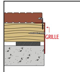
Exemple de grille de ventilation positionnée sous la lame
