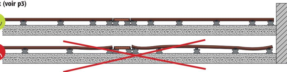
Chaque extrémité de lame doit avoir 2 lambourdes espacées d'un entraxe de 180 mm maxi. Pour la fixation de la lame intermédiaire perpendiculaire, voir page 12.
