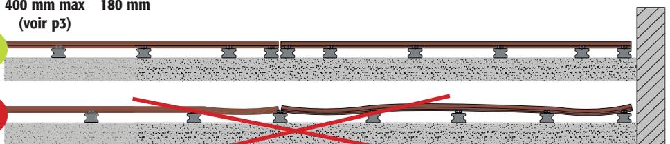
Chaque extrémité de lame doit avoir 2 lambourdes espacées d'un entraxe de 180 mm maxi. Pour la fixation des lames, voir page 10.
